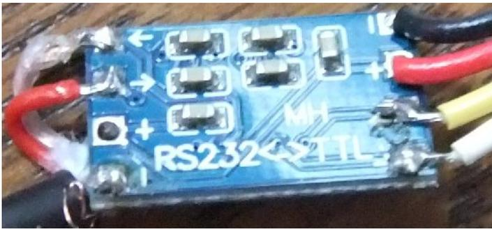
中国製変換基板の裏面
