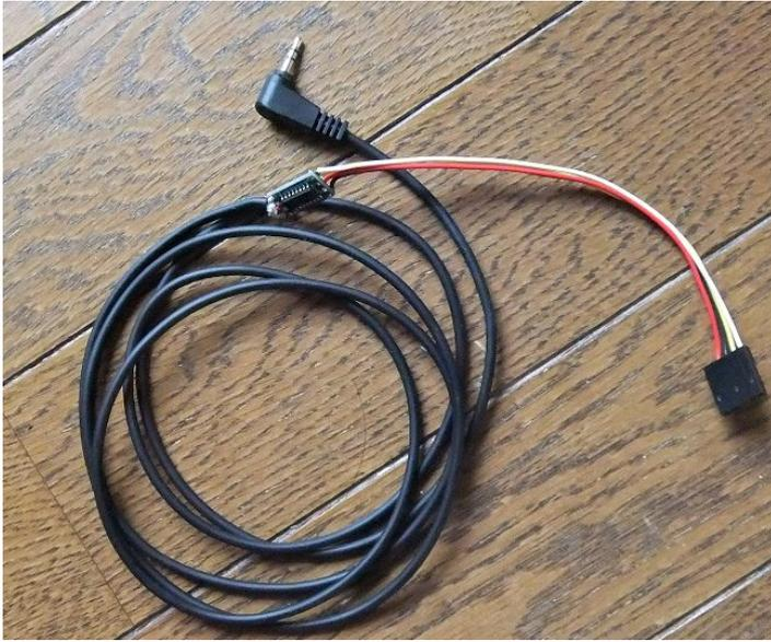
左の写真では、Raspberry Pi側は、QIコネクタの「信号伝達コネクタ」2550を使用しています。
