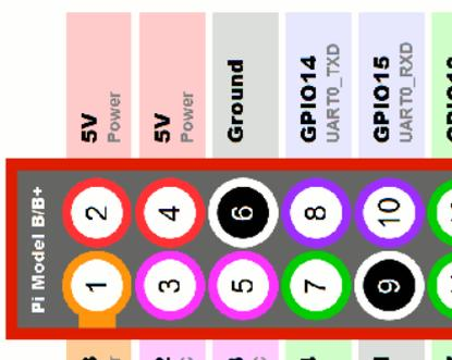
左側の図は、Raspberry PiのGPIO端子のピン配置です。(部品面からピンを左上にして、一番左側の図です。) このピンの内、2もしくは4から5V、6からGND、8からTXDそして10からRXDを取り出し、変換ICの各々の端子に接続します。
